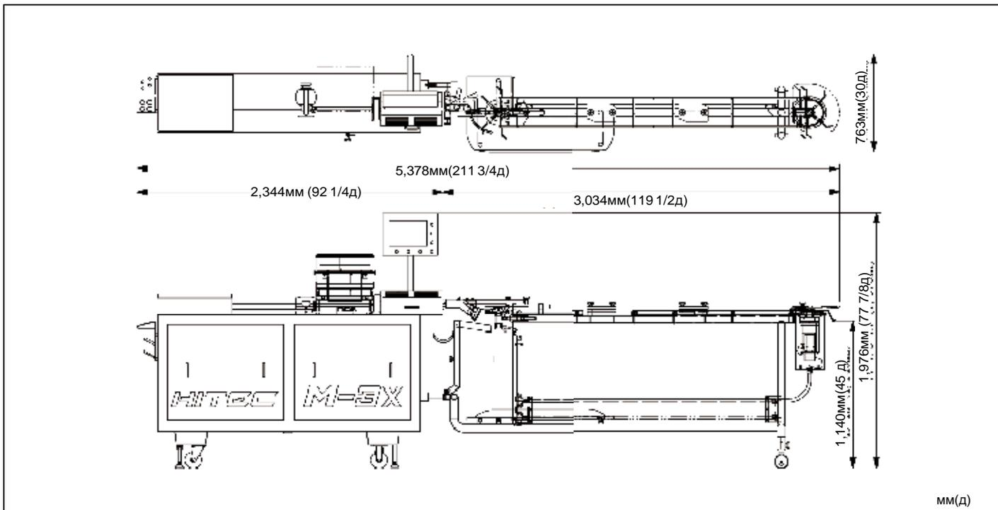
Выше приведены габариты линкера HITEC M-3X и конвейера 10 футов (3 м).
